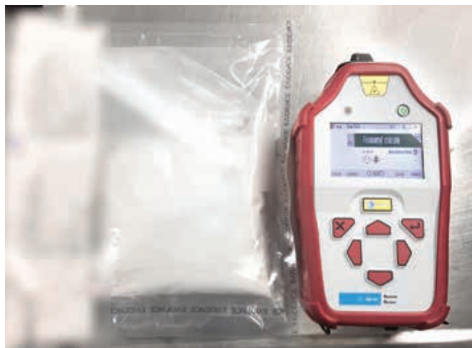
Figura 3. Barrido de fentanilo a través de varias capas de plástico
