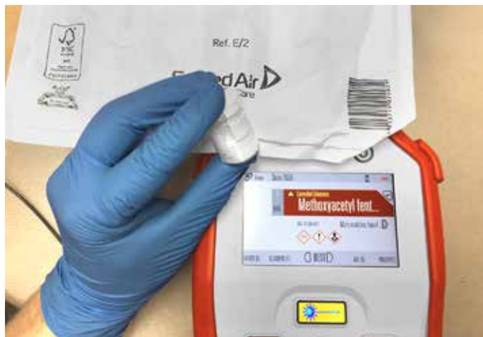
Figura 2. Barrido de muestra incautada de metoxiacetil fentanilo a través de papel blanco, papel marrón, envoltorio de burbujas y vidrio
