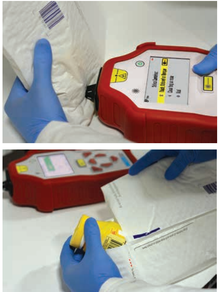
Figura 1. El sistema Agilent Resolve tiene la capacidad exclusiva de realizar el barrido a través de múltiples capas opacas de envases sin necesidad de un conocimiento previo sobre la muestra. Este ejemplo consta de varios comprimidos contenidos en una bolsa de plástico y una bolsa de correos opacas.
