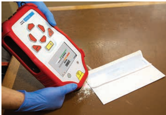
Figura 2. Modo de barrido superficial "visión directa"
