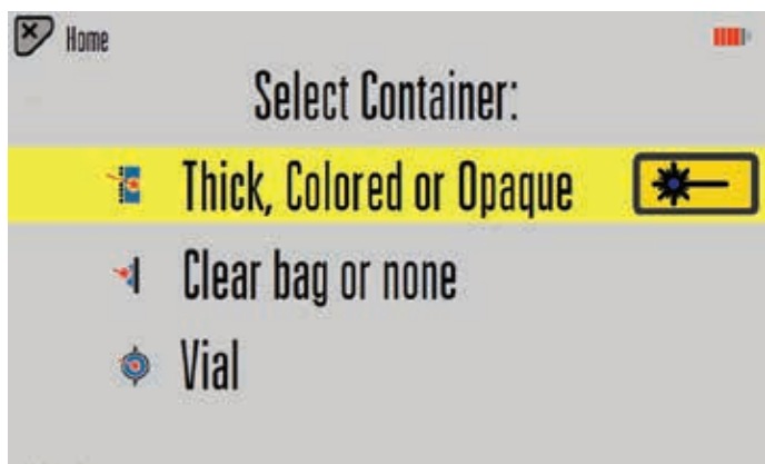
Figura 1. Opciones para medidas "a través de barreras", de tipo "apuntar y disparar" o de viales de vidrio.
