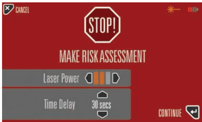
Figura 2. Pantalla de evaluación de riesgos en la que se puede configurar un tiempo de retardo o reducir la potencia del láser.
